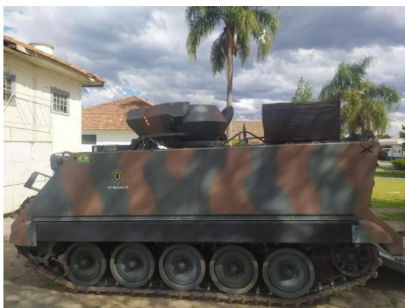
Figura 3: Vista lateral do Mockup da caixa da antena do Radar SABER M60 sobre a Vtr M113. Fonte: o autor.
