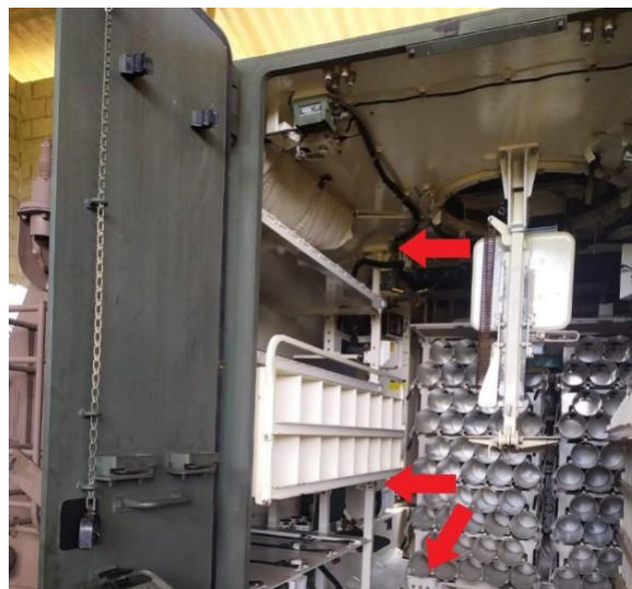
Figura 6: Detalhe dos parafusos de fixação das colmeias e prateleiras da VBTE Remun M992A2. Fonte: o autor.
