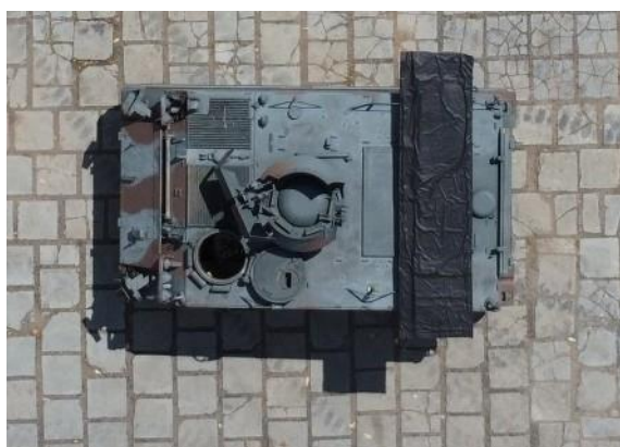
Figura 2: Vista aérea do Mockup da caixa da antena do Radar SABER M60 sobre a Vtr M113. Autor: 2º Ten PTTC Fuchs/ 11ª Bia AAAe AP.
