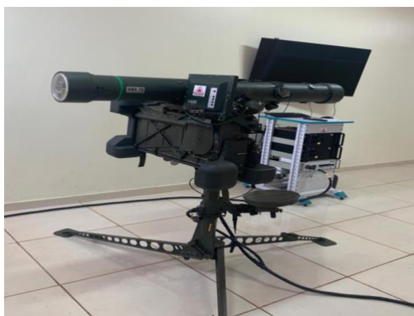
Figura 1 – Simulador virtual RBS 70 para adestramento do atirador (11º GAAAE) Fonte: Página da internet 11º GAAAE.
