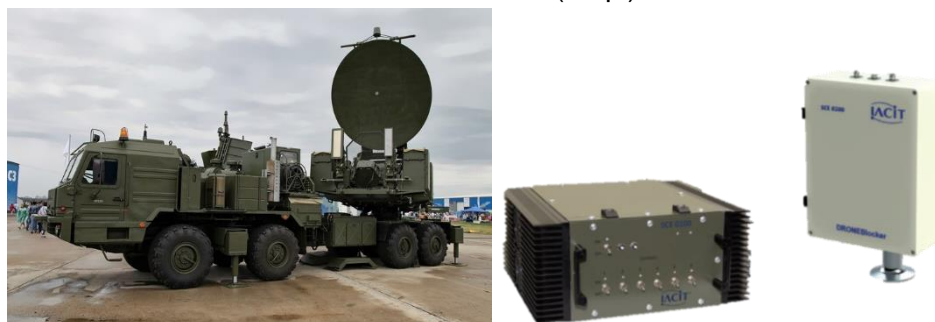
Figura 16 – Sistema de GE russo Krasukha-4 (esqu) e interferidor SCE 0100 (dirt)
