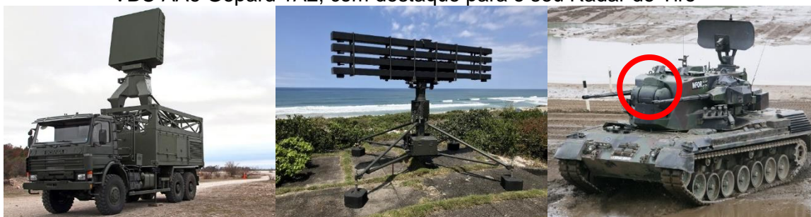
Figura 7 – Da esquerda para a direita, R Vig SAAB Giraffe 4A, R Bsc SABER M60 e VBC AAe Gepard 1A2, com destaque para o seu Radar de Tiro
