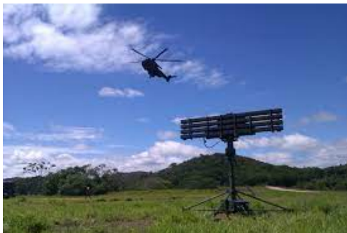
Figura 2: Radar Saber m60 - Fonte: CTEX. Disponível em: < http://www.ctex.eb.mil.br/projetos-finalizados/97-radar-de-defesa-antiaerea-de-baixa-altura-saber-m60 > Acesso em: 10JUN22
