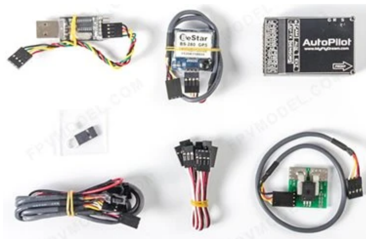
Figura 4 – Exemplo de placa controladora de voo com a possibilidade de voo automatizado. Possui GPS, estabilizador de voo, tubo de pitot, giroscópio. Disponível em: < https://fpvmodel.com/products/mfd-myflydream-autopilot-osd-flight-stablizer-2014_g433-html >. Acessado em: 19 JUL 21.
