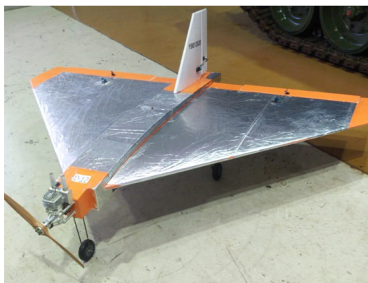
Figura 6 - Alvo aéreo Delta Eclipse revestido com folha reflexiva de alumínio. Fonte: 3º Sgt Leonardo/6ª Bia AAAe AP.
