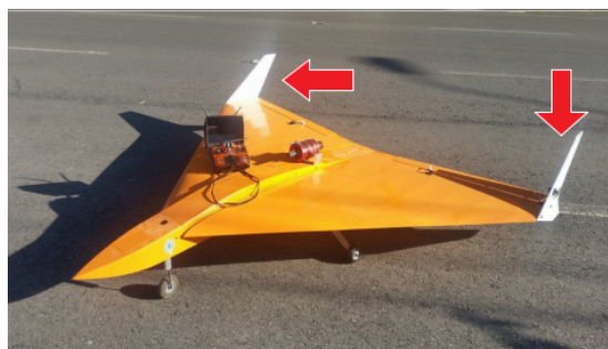
Figura 8 - Winglets. Disponível em: < https://www.brasilaircraft.com.br/produto/delta-jet >. Acessado em: 19 JUL 21.
